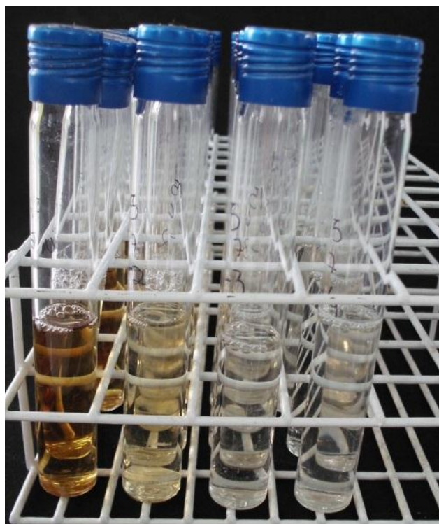
Figura 6. Tempo de contato de 15 horas com a linha de diluição de 10^7 UFC/mL (sendo o primeiro, o tubo neutralizante e os três seguintes a diluição com água peptonada).
