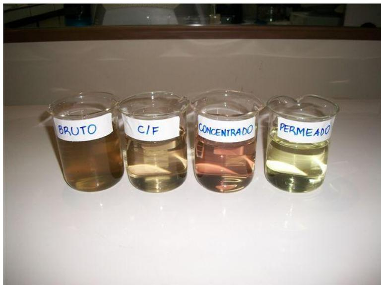
**Figura 21** Resultados visuais de coloração do efluente de alimentação, do efluente coagulado e floculado, do concentrado e do permeado obtidos com a UF
