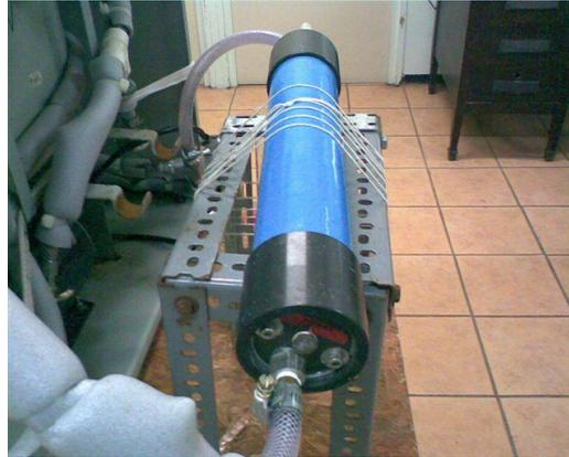
**Figura 12** Fotografia do módulo espiral de OI utilizado nos experimentos.
