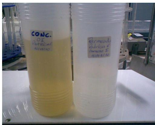
**Figura 23** Resultados visuais de coloração do concentrado e permeado obtidos com o módulo plano de OI
