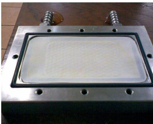
**Figura 11** Fotografia do módulo plano de UF, com vista do compartimento com a membrana.
