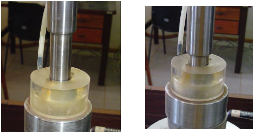
Figura 4.5: Cabeçote do corpo de prova e pistão de cargas da câmara triaxial desenvolvido nesta dissertação
