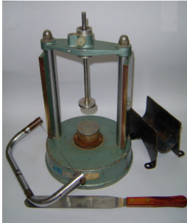
Figura 3.11: Equipamentos para moldagem de amostras indeformadas (torno, fio de arame, berço de amostras e espátula)
