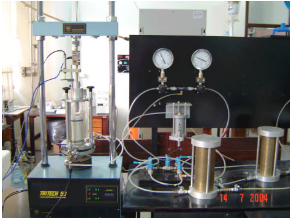
Figura 3.13: Equipamentos para ensaio triaxial instrumentado (câmara com capacidade de 800 kPa de tensão confinante)
