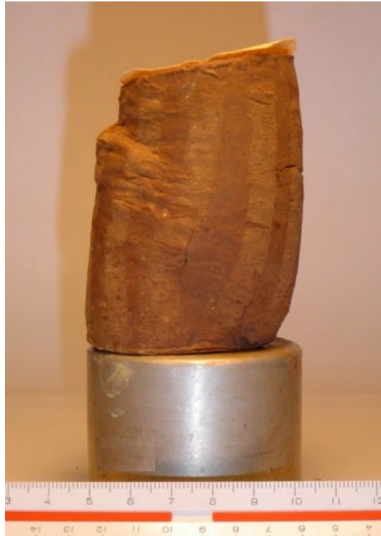
Figura 4.4: Formação de plano de ruptura nos corpos de prova reconstituídos, devida à rotação do cabeçote
