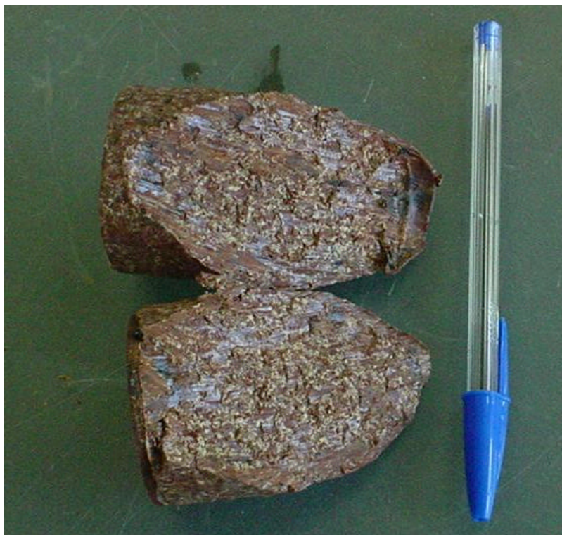
Figura 5.14: Superfície de ruptura observada no ensaio triaxial CID com tensão confinante efetiva de 800 kPa
