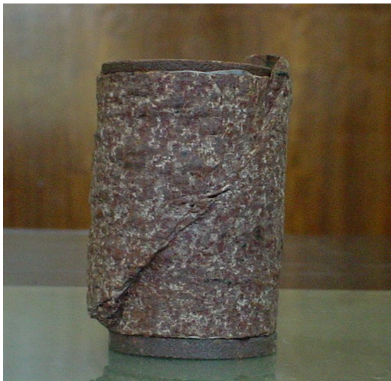
Figura 4.14: Padrão de ruptura dos corpos de prova indeformados (corpo de prova referente ao ensaio de 800 kPa)
