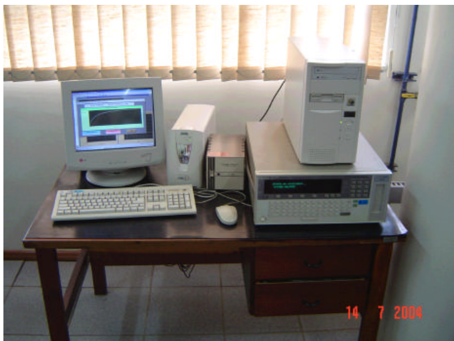
Figura 3.12: Equipamentos de aquisição e gerenciamento de dados para os ensaios triaxiais
