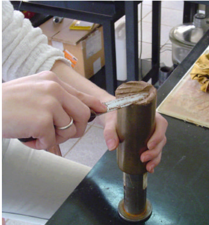
Figura 3.7: Moldagem dos corpos de prova
