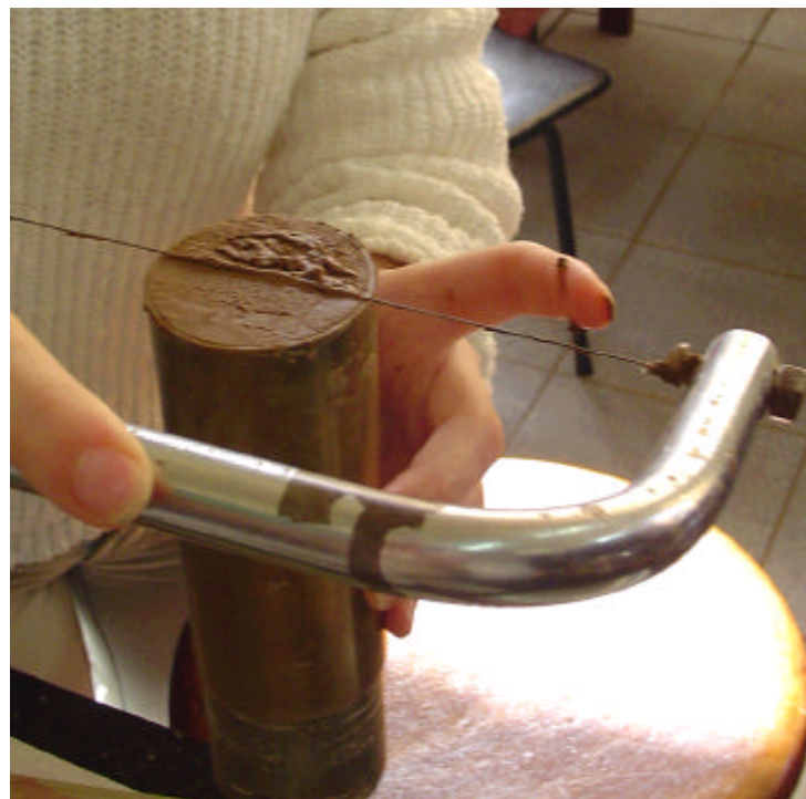
Figura 3.8: Rasamento do corpo de prova
