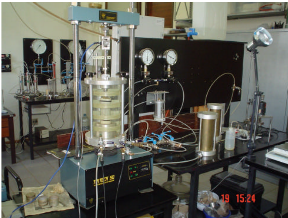
Figura 3.14: Equipamentos para ensaio triaxial instrumentado (câmara com capacidade de 1700 kPa de tensão confinante)
