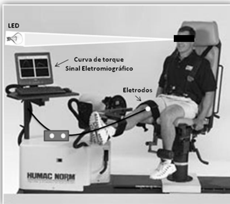
Figura 3. Ilustração da posição do indivíduo no dinamômetro isocinético para realizar os testes de extensão de joelho.
