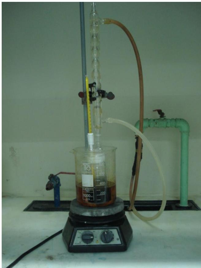
Figura 3. Sistema de refluxo empregado para o processo de síntese dos catalisadores.
