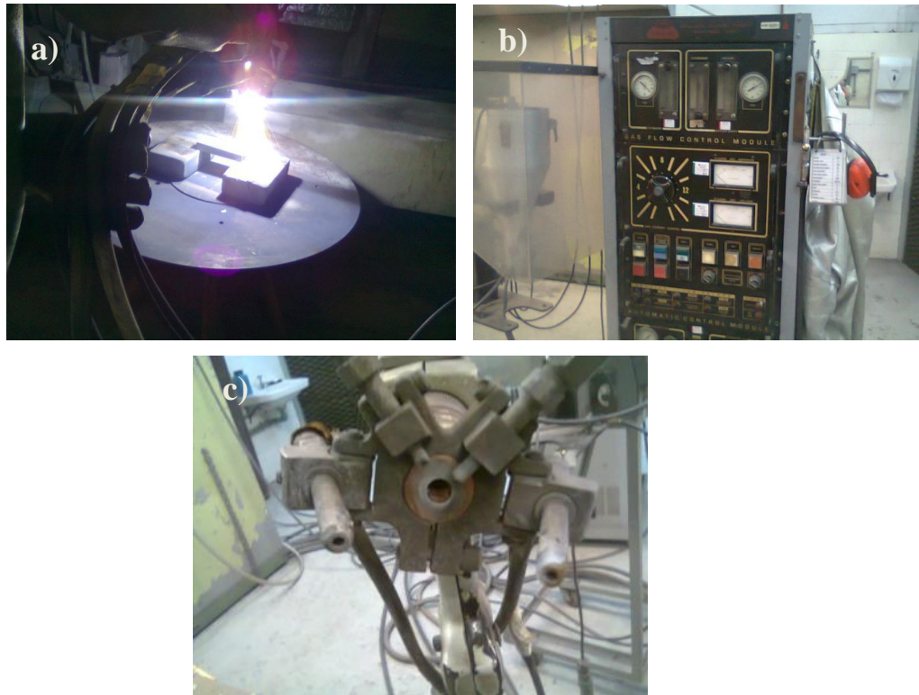
Figura 17 – Processo de aspersão térmica a plasma (PS) sendo realizado nos corpos de prova retangulares em (a), equipamento de plasma spray em (b) e pistola de aspersão a plasma em (c)
