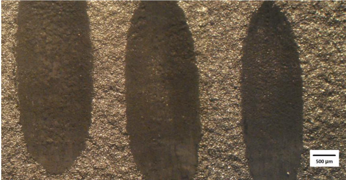
Figura 49 – Trilhas de desgaste realizada no tribômetro para a amostra 1Nb
