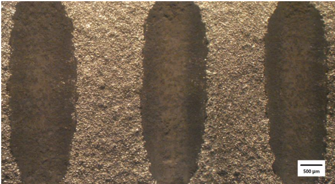
Figura 51 – Trilhas de desgaste realizada no tribômetro para a amostra 5Nb
