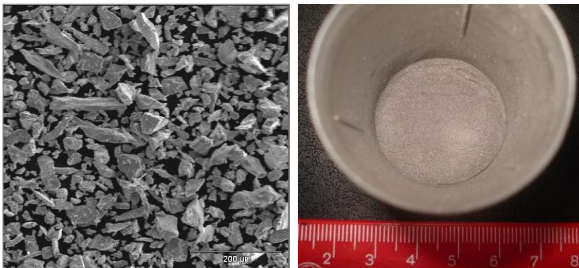
Figura 26 – Morfologia irregular do pó de nióbio obtida por MEV em (a) e o aspecto do pó de nióbio como recebido em (b).
