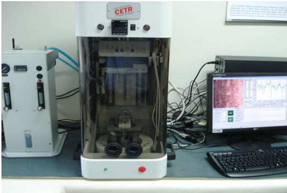
Figura 20. Tribômetro empregado nos ensaios de desgaste.
