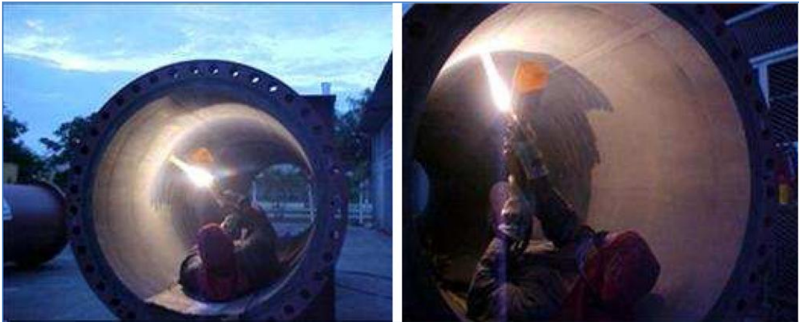
Figura 15 – Aplicação do \text{Nb}_2\text{O}_5 por aspersão térmica a chama oxiacetilênica (57) .
