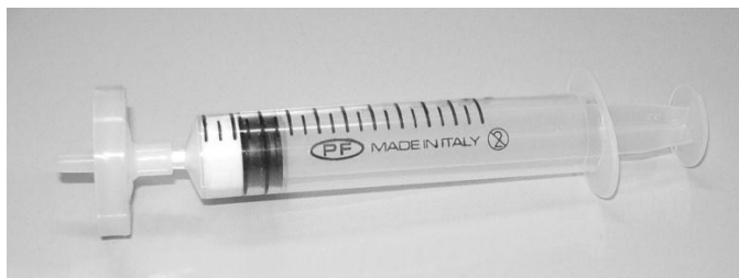
Figura 01- Coluna de polivinilpirrolidona (PVP).
