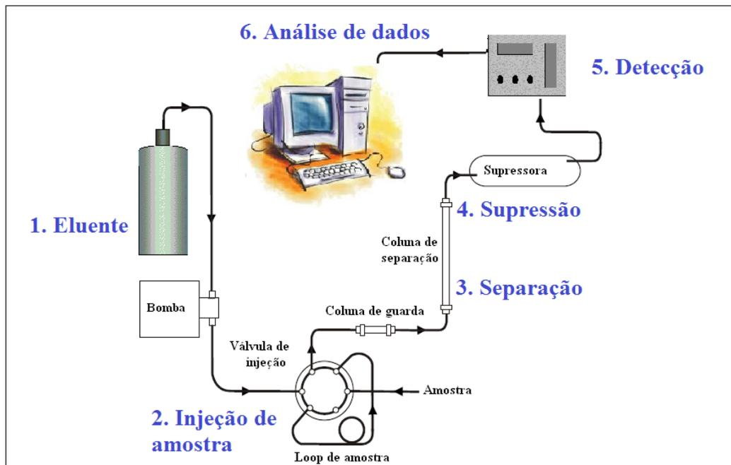
**Figura 5:** Componentes básicos de um cromatógrafo iônico <sup>(24)</sup>
