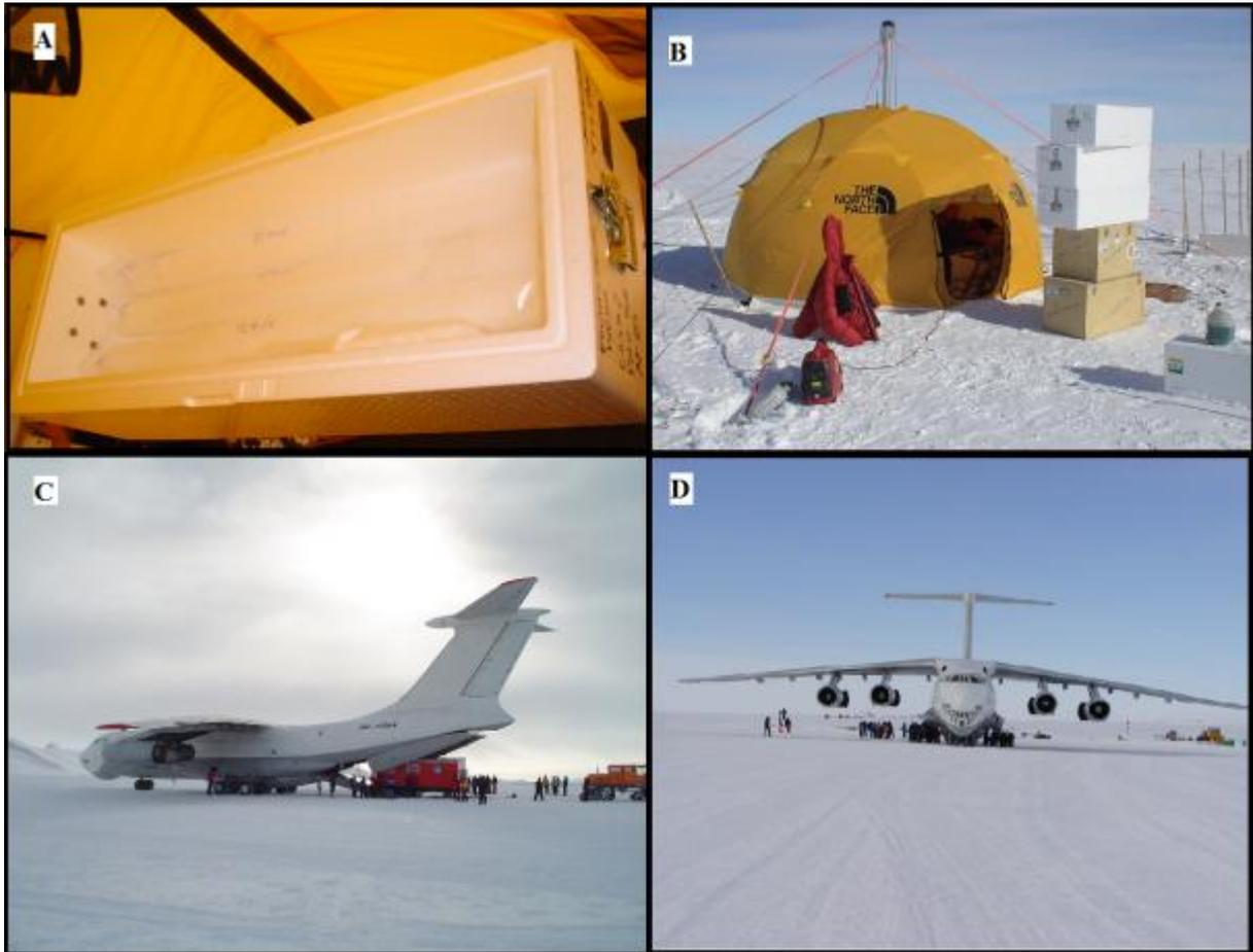
**Figura 15:** (A) Testemunhos de gelo embalados, dispostos na caixa para transporte. (B) Caixas de isopor contendo testemunhos de gelo no acampamento. (C) e (D) Avião carregado para retorno dos equipamentos utilizados na travessia e transporte dos testemunhos de gelo coletados.
