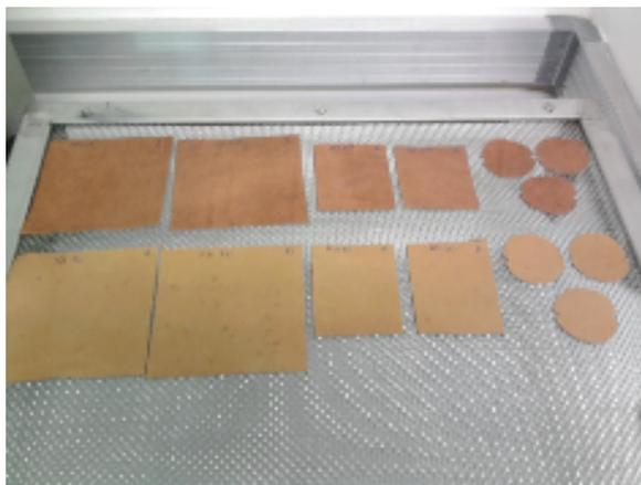
**Figura 3.2:** Corpos-de-prova para os testes de resistência à passagem de água de Maeser, e distensão da flor- Lastômetro respectivamente.
