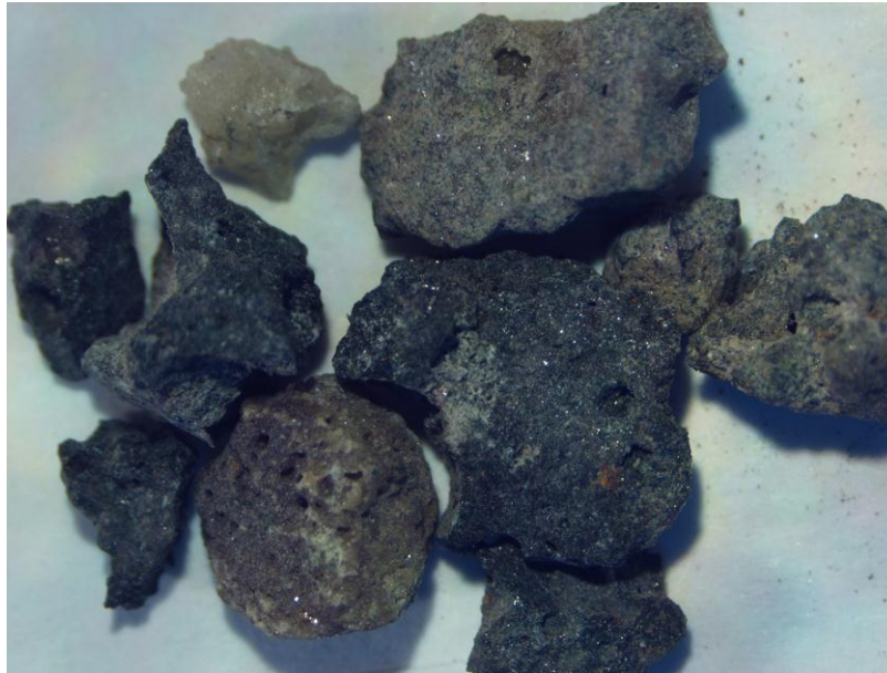
Figura 22: Foto em lupa da escória antes do tratamento da DAM.
