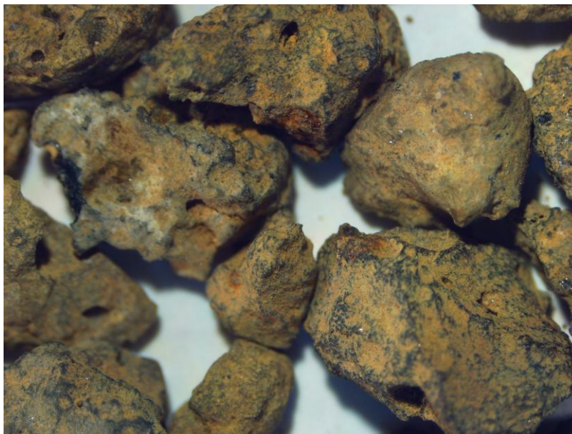
Figura 23: Foto em lupa da escória após tratamento da DAM, destacando a presença da camada de hidróxido de ferro recobrindo o material.
