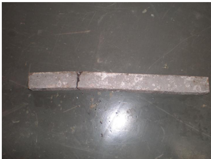
Figura 25: Foto da barra rompida.
