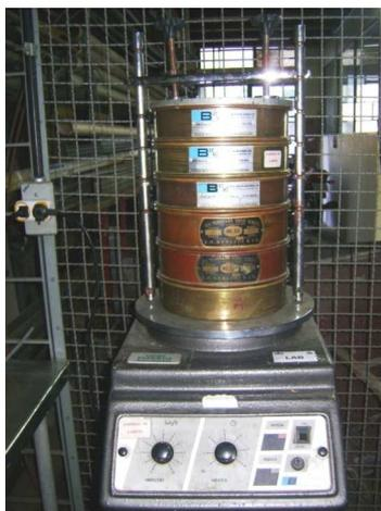
**Figura 3.1:** Ensaio granulométrico e distribuição em série de peneiras Tyler.
