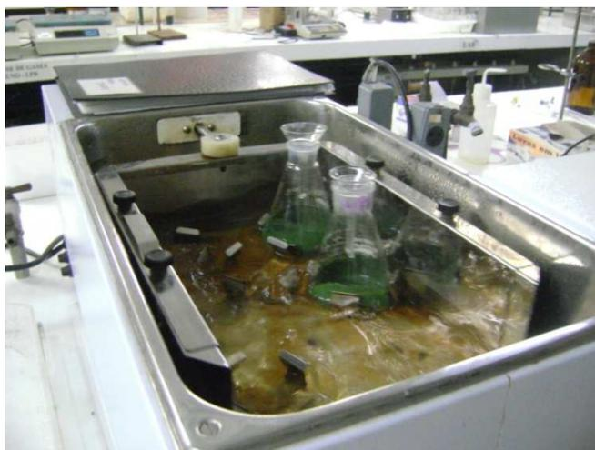
**Figura 3.3:** Experimentos realizados em banho termostático.
