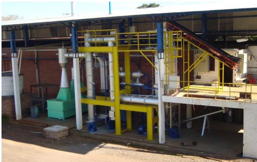
**Figura 2.3:** Planta piloto para tratamento térmico de resíduos de couro.
