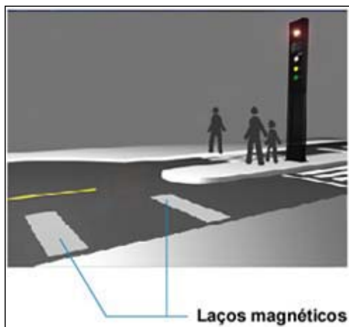
FIGURA 2.1 - Laços magnéticos para detectar velocidade
