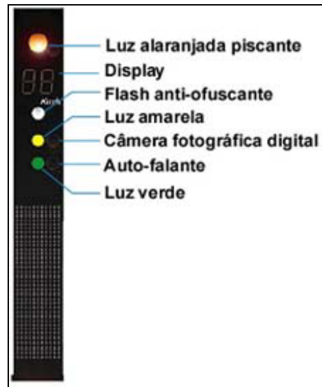
FIGURA 2.10 – Sinalizações de uma Lombada Eletrônica
