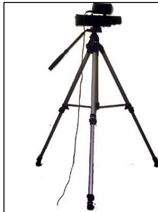
FIGURA 2.4 - Radar instalado num tripé
