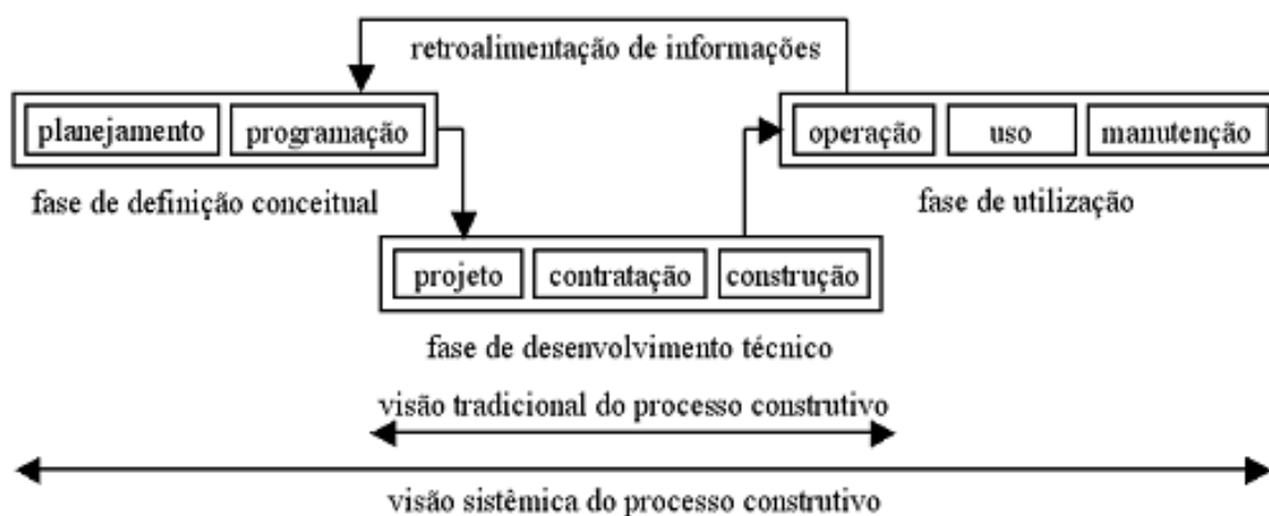
Figura 8: visão sistêmica do processo construtivo (BONIN, 1987 apud NOVAES, 1996, p. 51)
