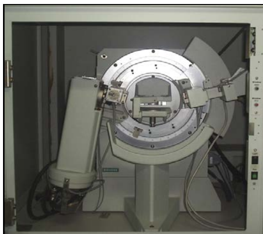
Foto 24. Espectrômetro do tipo Bragg Brentano, difratômetro SIEMENS, modelo D5000 com goniômetro \theta - \theta , laboratório de difratometria de Raios X, IGEO – UFRGS.
