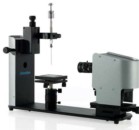
Figura 3: Equipamento típico utilizado para medições de tensões superficiais através do método da gota pendente.
