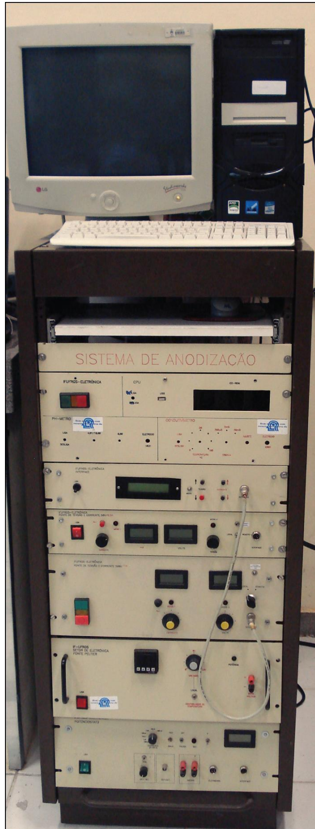
Figura 19. Sistema de anodização composto por fontes de tensão e controlador.
