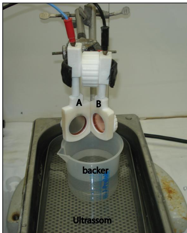
Figura 18. Célula eletroquímica de anodização, A corresponde ao ânodo (Ta) e B cátodo (Cu).
