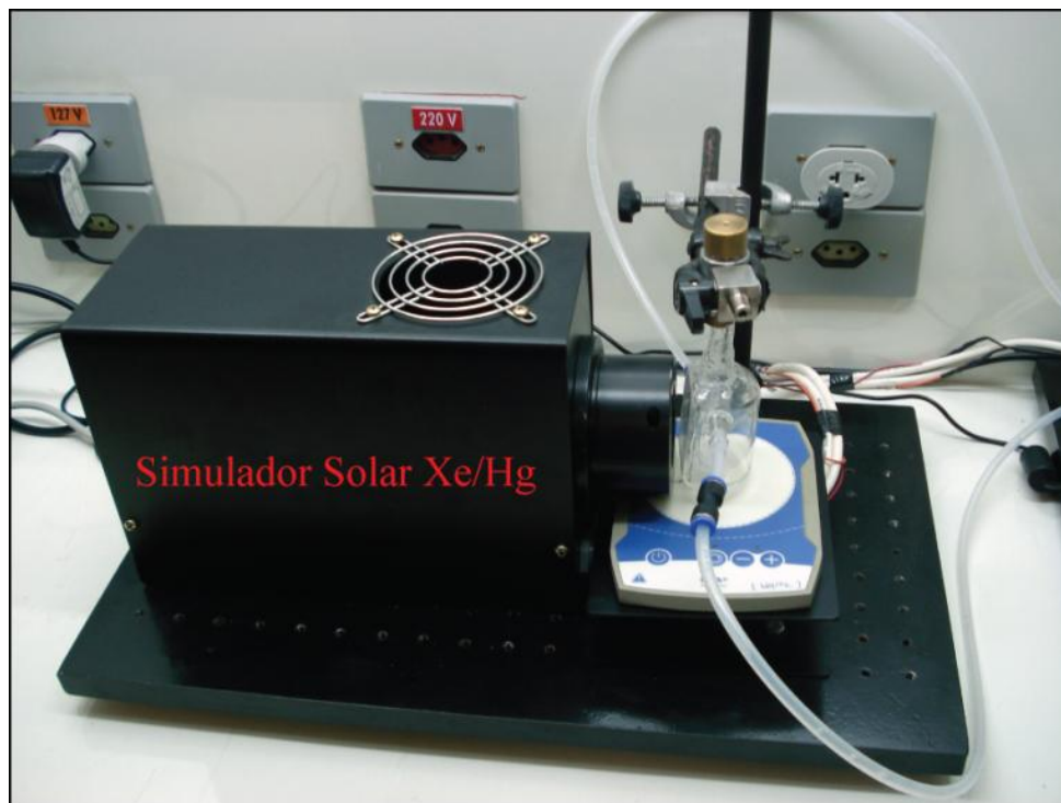
Figura 21. Simulador solar equipado com uma lâmpada de Xe/Hg.
