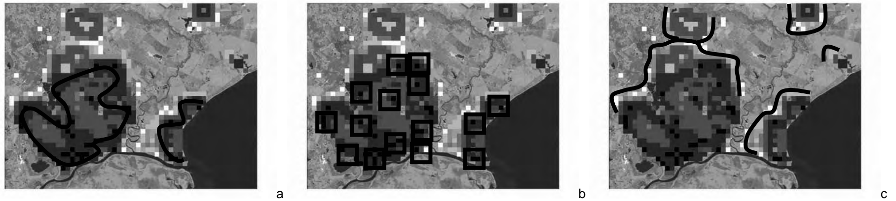
Figura 6.34: hipótese de crescimento superior, sobre output de LoadU, na iteração 45, mostrando a distribuição dos carregamentos; a) linhas com carregamentos elevado, nas regiões de solo convertido para urbano no processo de crescimento; b) pontos de carregamento máximo que flutuam pelo sistema; c) ocorrência de carregamentos mínimos.
