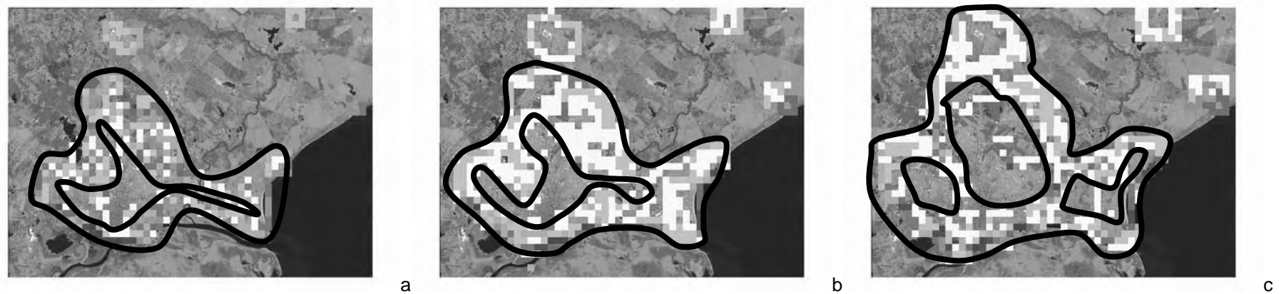
Figura 6.36: hipótese de crescimento superior, sobre output de Potential , mostrando as faixas largas de incidência; a) na iteração 1 (início); b) na iteração 22 (meio); c) na iteração 45 (fim).
