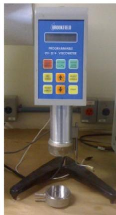
Figura 16 – Viscosímetro utilizado para determinar a viscosidade do fluido em várias temperaturas.
