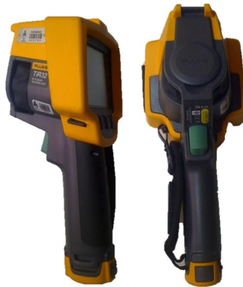
Figura 17 – Equipamento Fluke TiR32 Thermal Imager utilizado para aferir a temperatura do molde.
