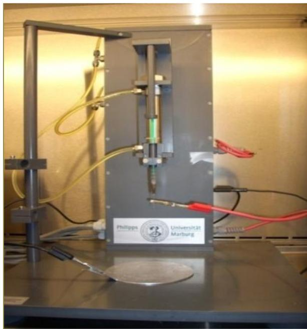
**Figura 3. Aparato de *electrospinning* (Laboratório de Células-tronco e Hematologia da Faculdade de Farmácia – UFRGS)**
