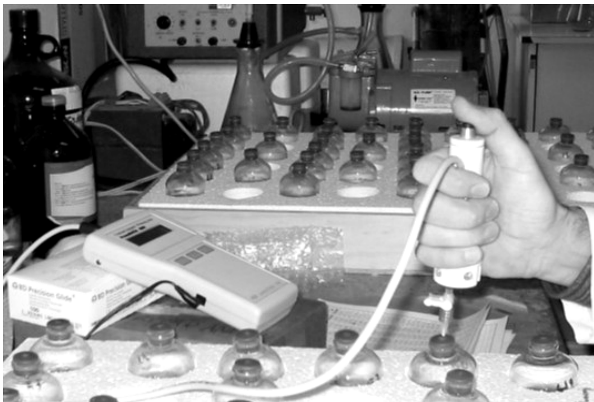
FIGURA 2.4.1 – Transdutor de pressão em uso na UFSM para a técnica semi-automatizada de produção de gás, descrita por Maurício et al. (1999).
