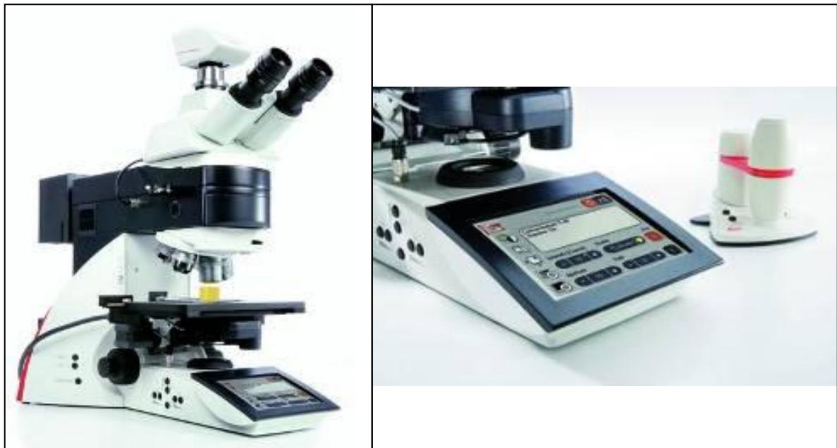
Figura 26 – A: Microscópio de luz refletida utilizado nas análises da Reflectância da Vitrinita. B: Detalhe dos comandos do microscópio.
