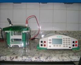
Fig. 3. Figura ilustrativa de equipamento de eletroforese.
