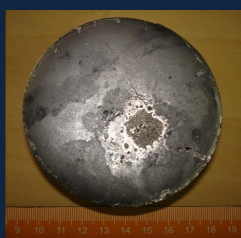
FIG.2 Amostra de aço remanescente do cadinho.
