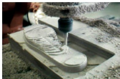
Figura 6.25 - Operação de acabamento.
