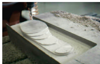
Figura 6.24 - Operação de desbaste.
