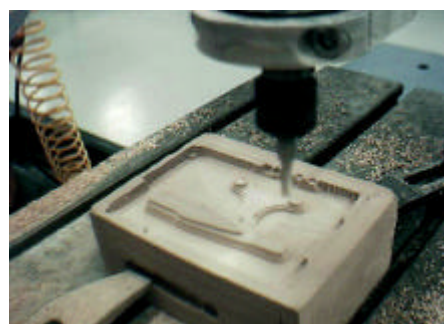
Figura 6.8 - Operação de desbaste.
