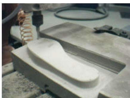
Figura 6.27 - Fase final de acabamento.
