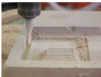
Figura 6.18 - Operação de desbaste.
