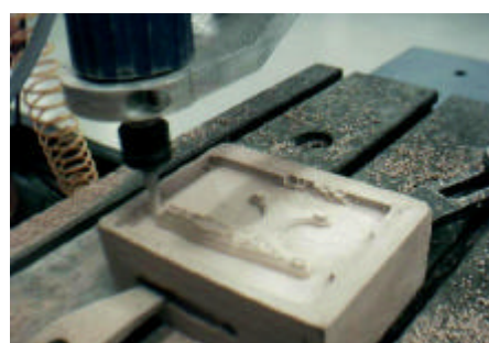
Figura 6.10 - Início de operação de acabamento.
