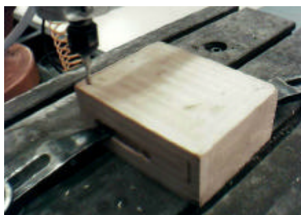
Figura 6.7 - Referência zero peça.
