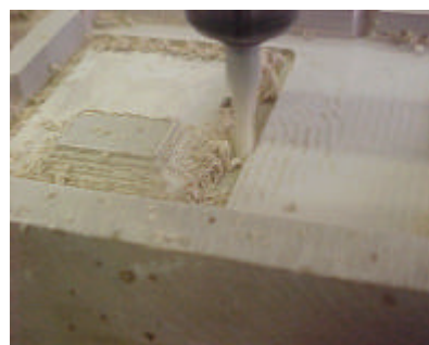
Figura 6.19 - Execução de cavidade.
