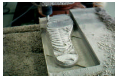
Figura 6.26 - Fase intermediária de acabamento.
