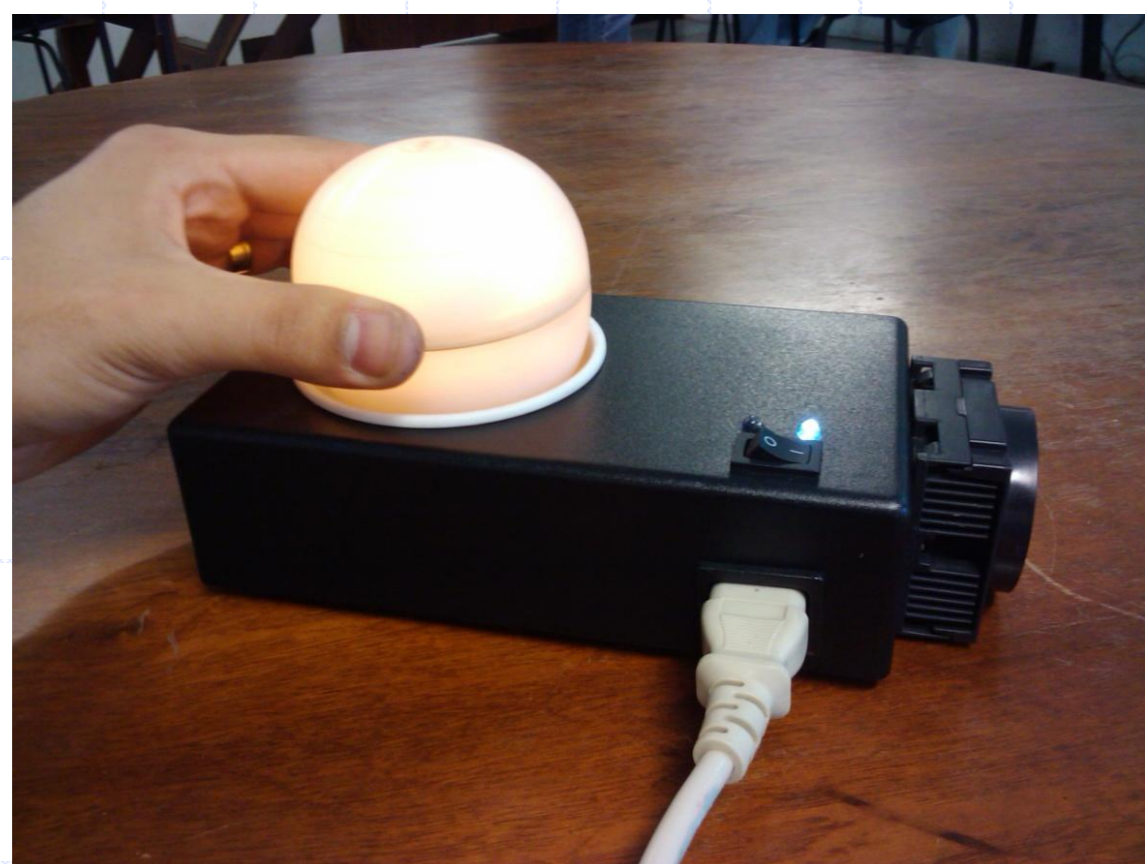
Figura 1 – Sistema de transferência de energia sem fio, com bobina primária na base e secundária no interior da esfera.
