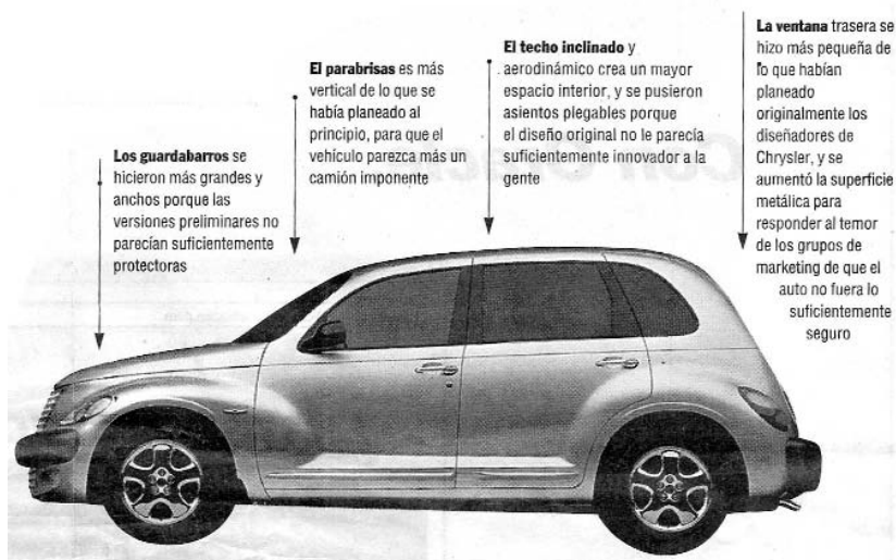
4.5.10 Chrysler PT Cruiser, desenhado seguindo as respostas de grupos de opinião consultados em diferentes cidades dos EUA, da Europa, da América do Sul e da Ásia. Publicado em The Wall Street Journal
