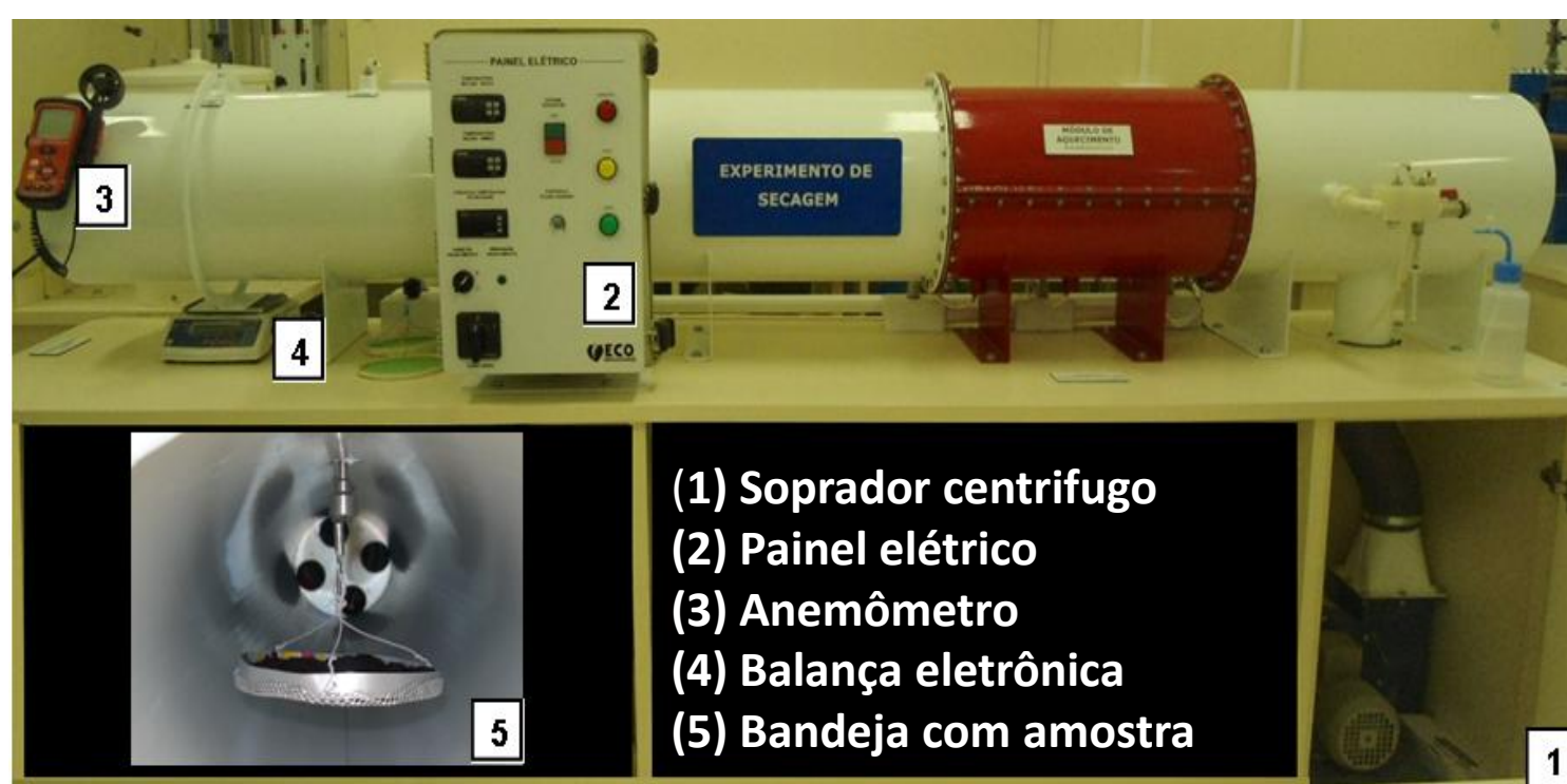
FIGURA 1 – Secador de leito fixo.
