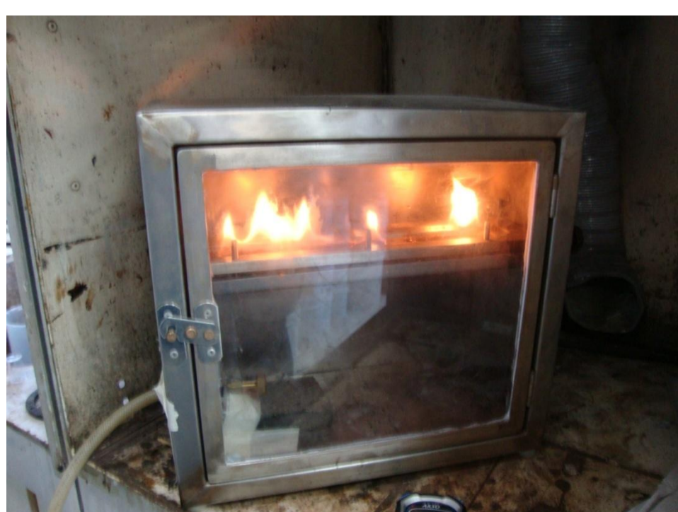
Fig. 2. câmara de combustão em funcionamento.
