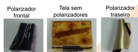
Figura 7 – Remoção Térmica
