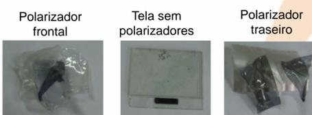
Figura 6 – Remoção por acetona
