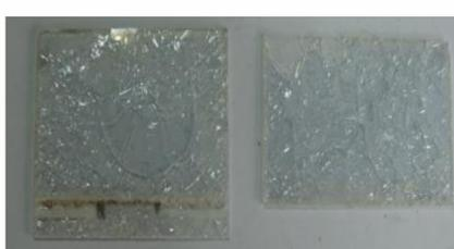
Figura 8 – Choque térmico módulo LCD
