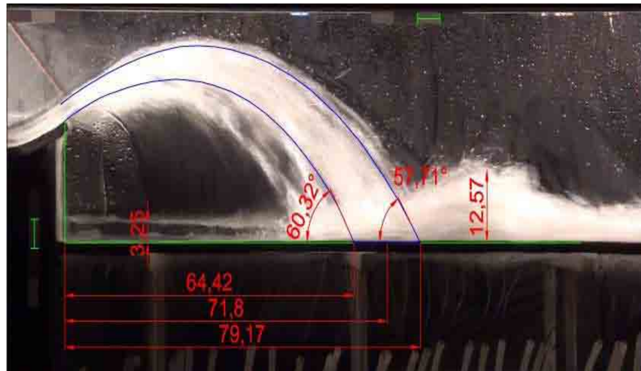
Imagem analisada do Modelo em escala 1:100 no Laboratório de Obras Hidráulicas – LOH/IPH
