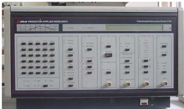
Figura 9 – Potenciostato / Galvanostato EG&G 273A
