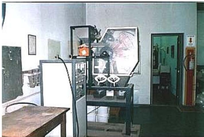
*Figura 8 – Separador Eletrostático*
