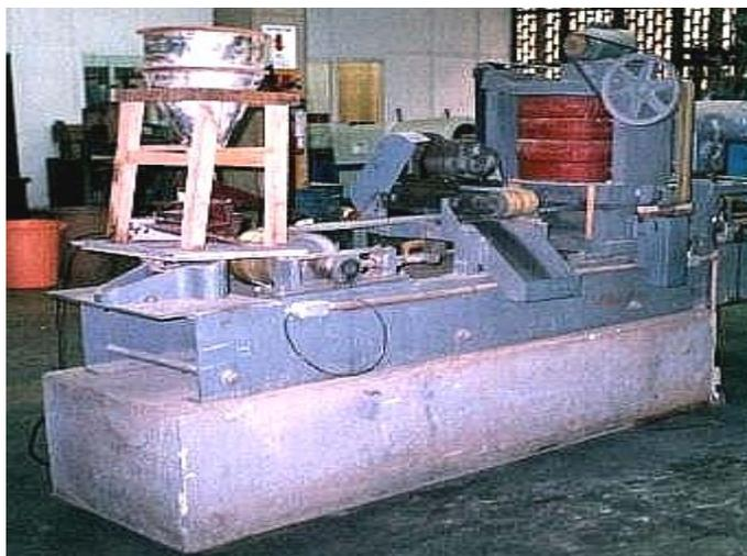
*Figura 7 – Separador Magnético de Correias Cruzadas à Seco*
