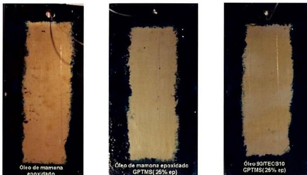
**Figura 6:** Placas de alumínio revestidas com os filmes híbridos após o ensaio de proteção à corrosão.
