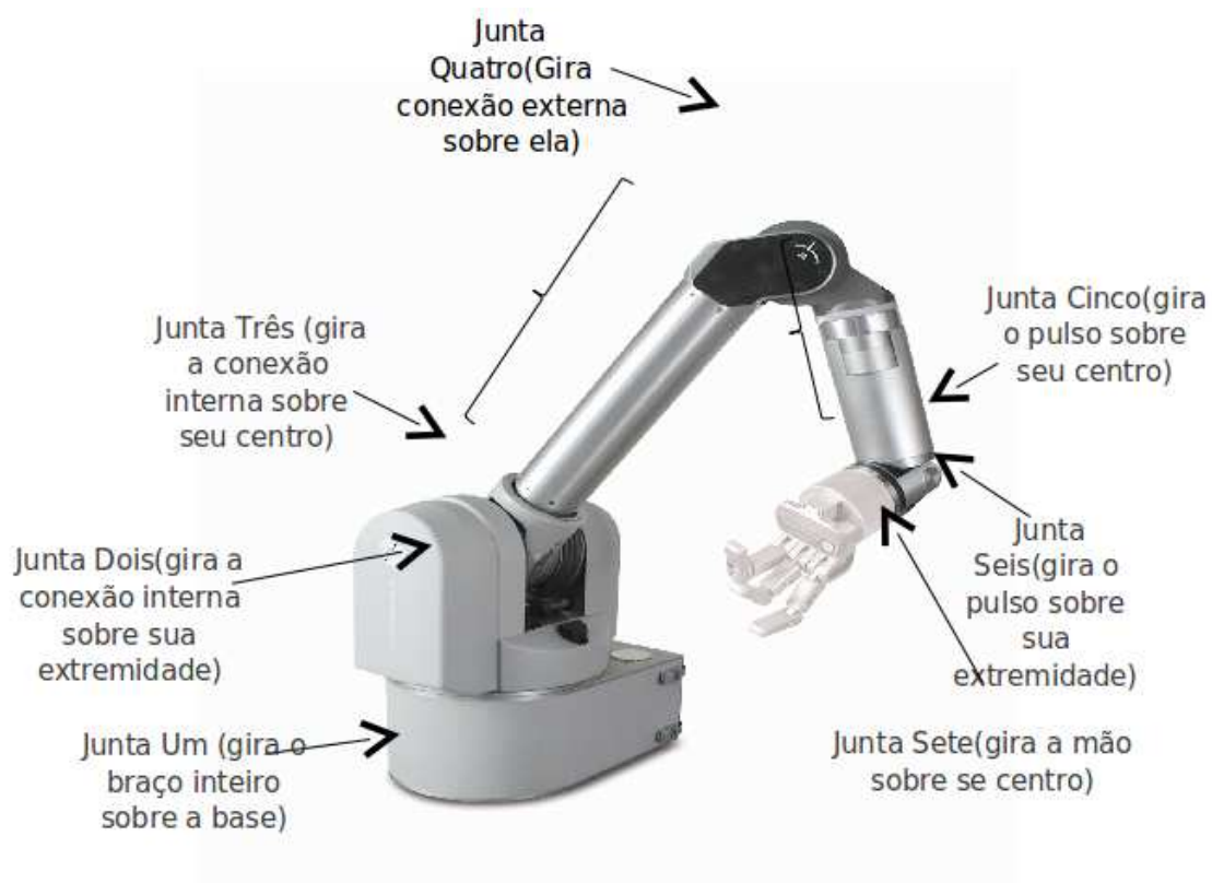
Figura 3: Juntas do Robô Barrett WAM.
