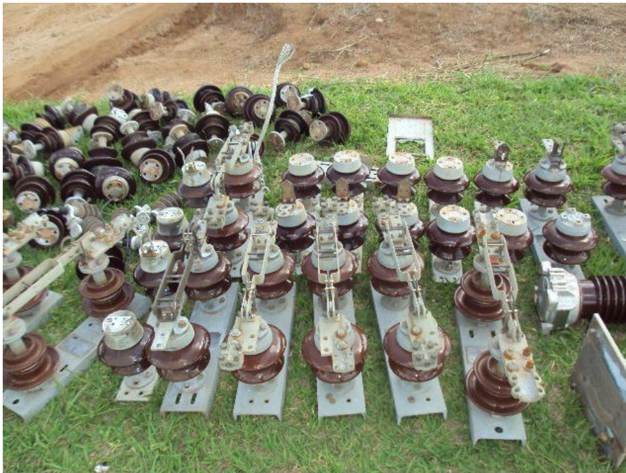
Figura 9. Chaves Seccionadoras Unipolar 15kV (BT).
