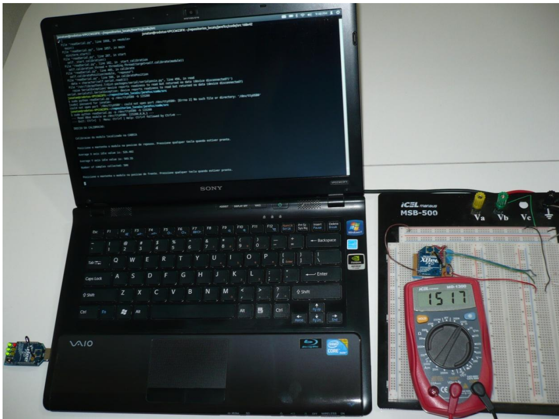
Figura 4.6 - Teste de transmissão e recepção dos valores dos acelerômetros.
