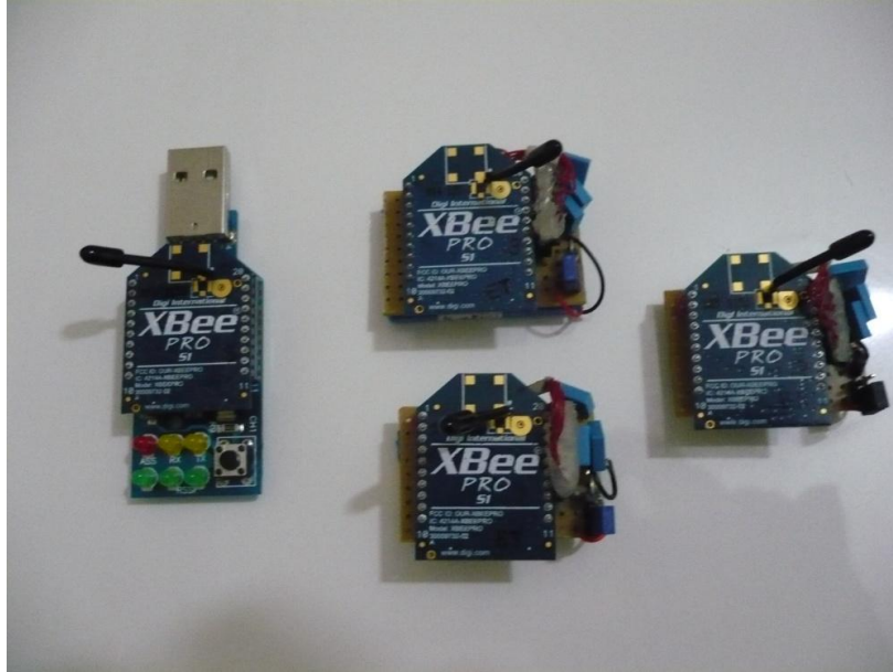
Figura 3.14 - Componentes do sistema sem fio de acelerometria.
