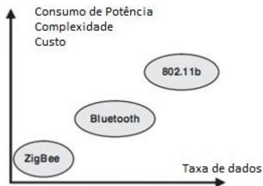
Figura 2.1 - Comparação do padrão ZigBee com Bluetooth e IEEE 802.11b.
