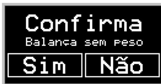
Figura 15 - Tela de confirmação que o silo balança encontra-se sem peso
