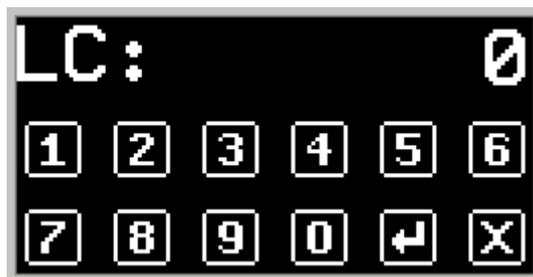
Figura 27 - Tela de digitação do limite de carregamento
