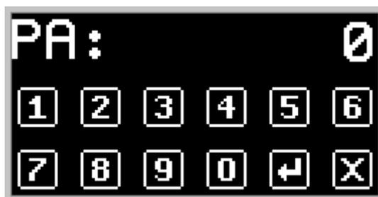
Figura 34 - Tela de digitação do peso de amostra
