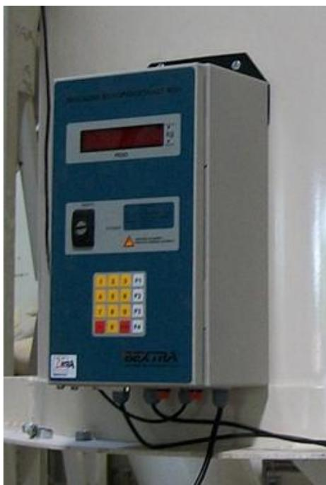
Figura 3 - Comando eletrônico da balança de fluxo <sup>[3]</sup>
