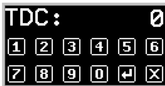
Figura 22 - Tela de digitação do tempo entre descarga e carga
