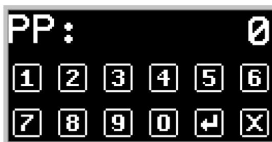
Figura 20 - Tela de digitação do peso programado
