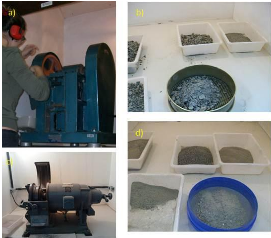
Figura 18: Etapas sucessivas de preparação de amostras. a) Britador; b) peneira < 6mm; c) Moinho; d) Peneira < 500 \mu\text{m} .
