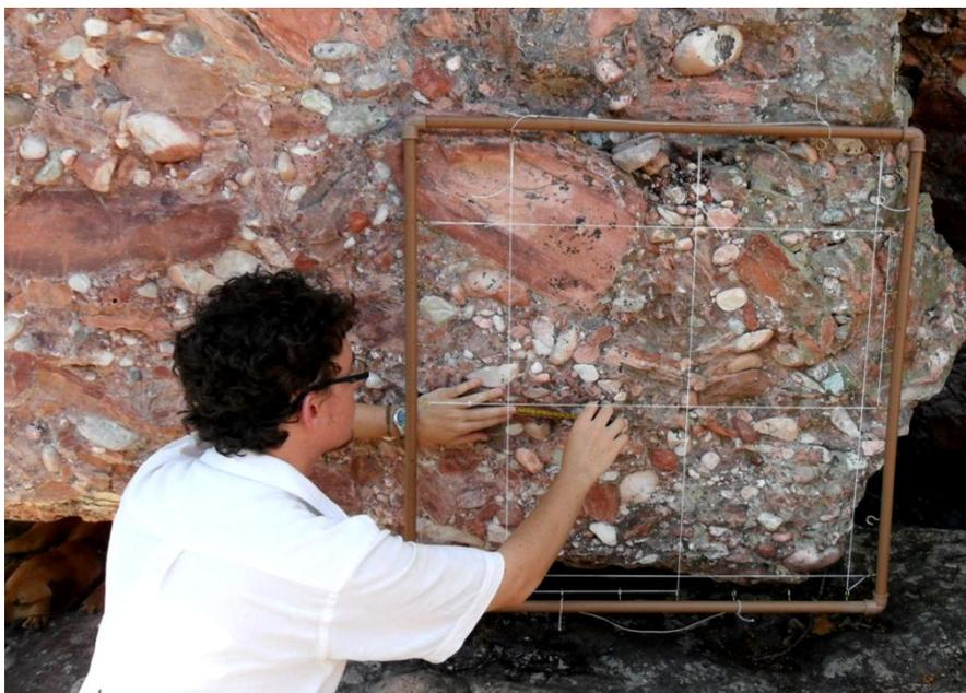
**Figura 14.** Malha para contagem de clastos com equidistância de 20 cm.
