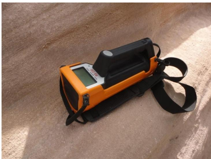
**Figura 10.** Espectrômetro portátil de raios gama utilizado no projeto.
