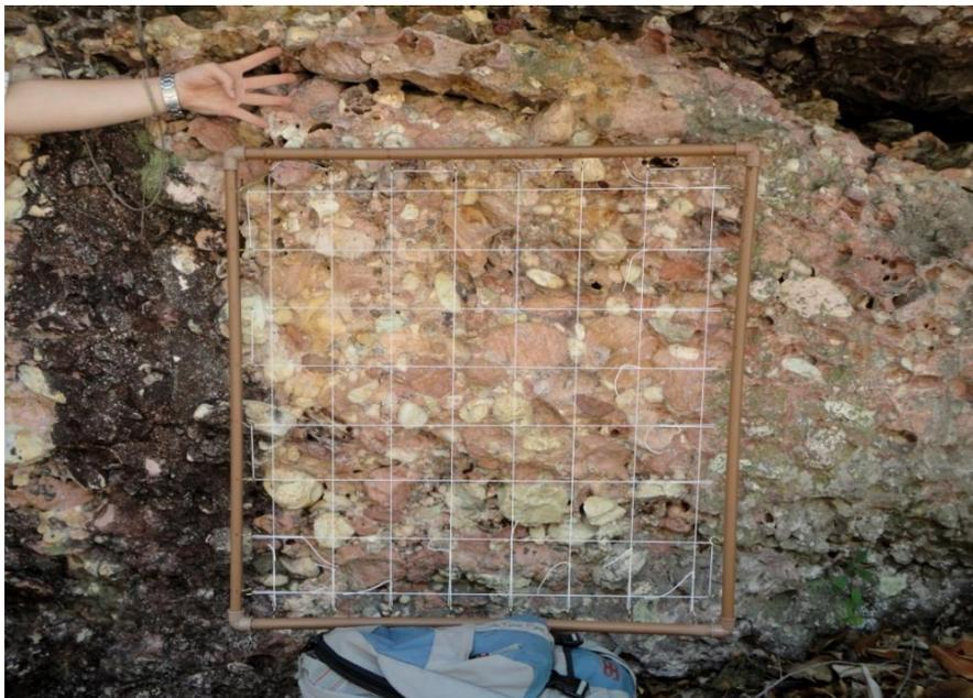
**Figura 13.** Malha para contagem de clastos com equidistância de 10 cm.
