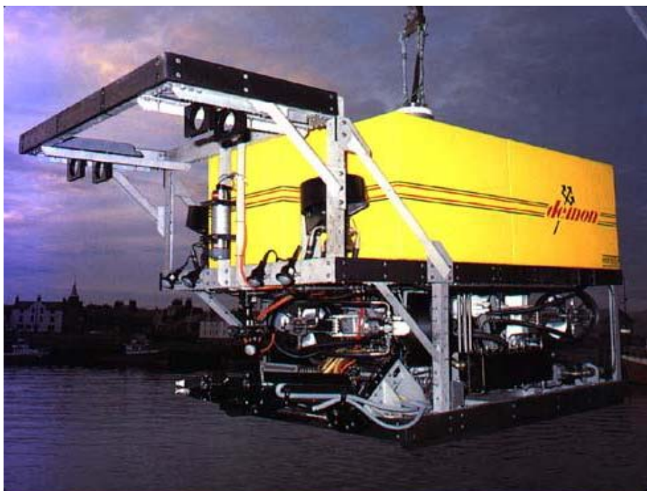
Figura 19. Exemplo de um ROV (Remotely Operated Vehicle), utilizado para diversos fins operacionais, dentre eles a inspeção externa de dutos.
