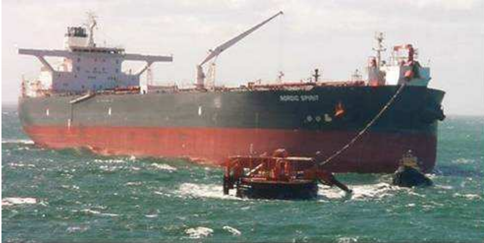
Figura 25 – Monobóia MN 602, em operação de descarga de petróleo.
