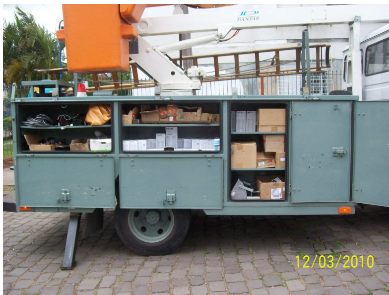
Figura 5.2 - Acondicionamento dos materiais no veículo
