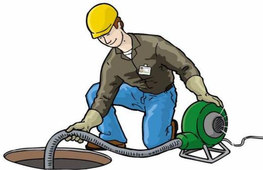
Figura 3 - Ventilação com insuflador portátil (FUNDACENTRO, 2006)
