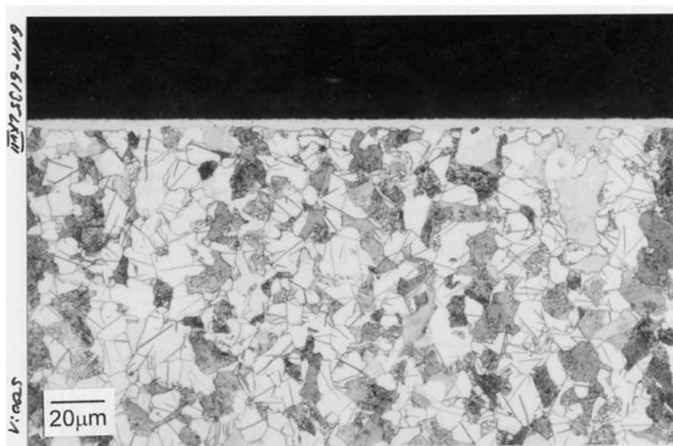
Figura 4.25 – Metalografia mostrando a camada obtida através da nitretação a  $540^{\circ}\text{C}$  e composição gasosa de 5%  $\text{N}_2$  – 95%  $\text{H}_2$ .
