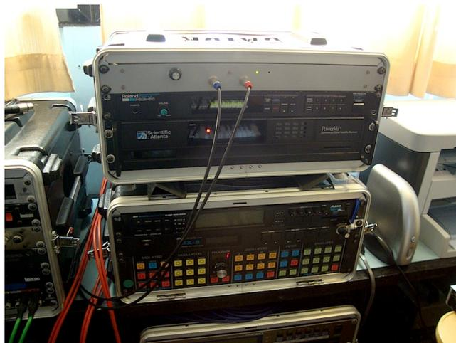
Figura 6.4: Interface de gravação, Roland MKS-50, Fonte de Alimentação e Studio Electronics ATC-1
