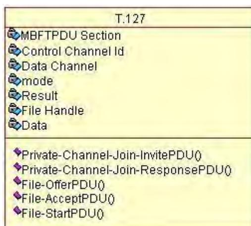
Figura 4.12: Representação através da UML do T.127
