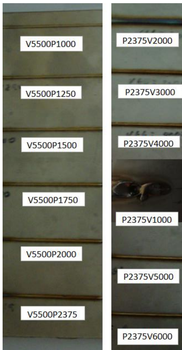
Figura 18 – Vista superior dos cordões de solda
