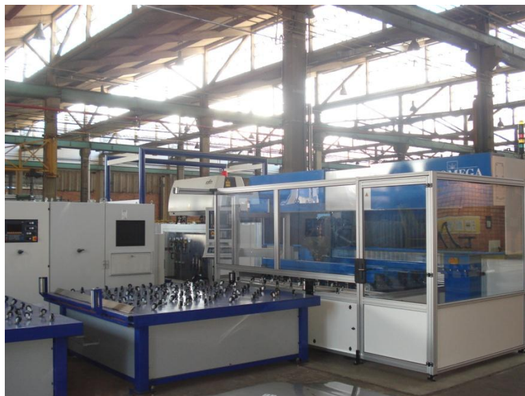
Figura 17 – Máquina de solda Omega Quadra Clamp 1S. (Fonte: Liess Máquinas e Equipamentos)
