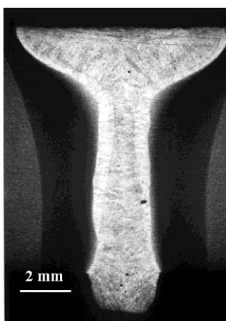
Figura 6 – Macrografia de uma junta de aço carbono soldada a laser. (10)
