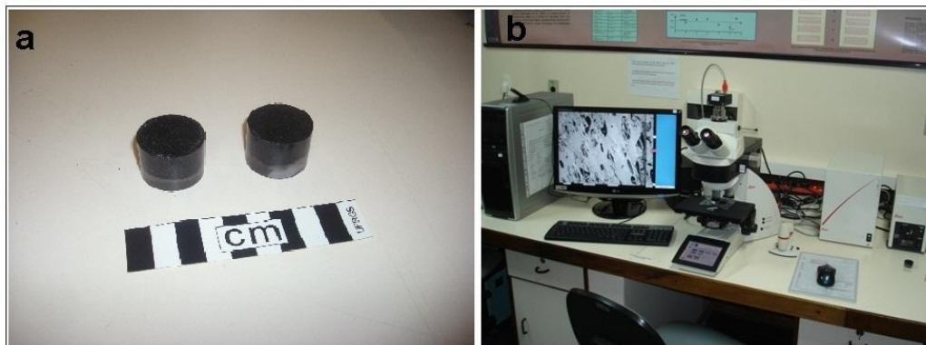
Figura 12—Equipamentos utilizados para as análises de reflectância. (a) Plugues com a superfície polida; (b) Microscópio Leica DM6000 M de luz refletida.
