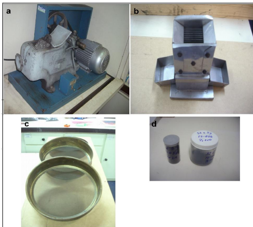
Figura 10—Equipamento onde são realizadas as etapas de preparação das amostras de carvão; (a) britador; (b) quarteador; (c) peneira; (d) amostra armazenada.
