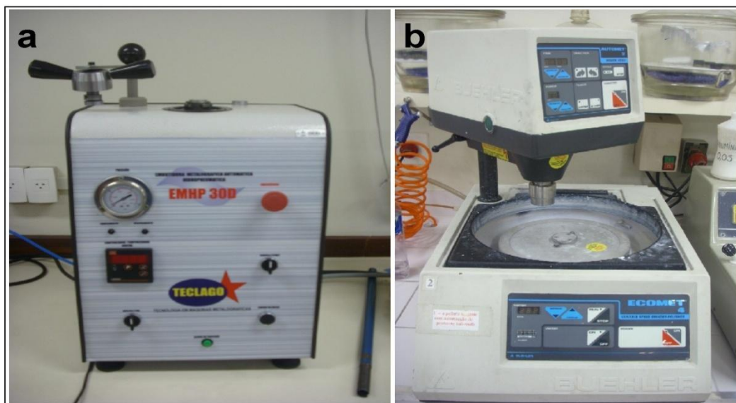
Figura 11–Equipamentos utilizados para a confecção das seções polidas de amostras. (a) embutidora metalográfica; (b) lixadeira automática
