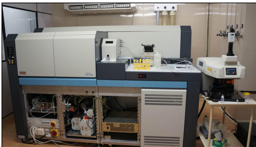
Figura 4: Caracterização do equipamento ICP-MS, foto cedida pelo Laboratório de Geologia Isotópica, Instituto de Geociências, UFRGS, 2012.
