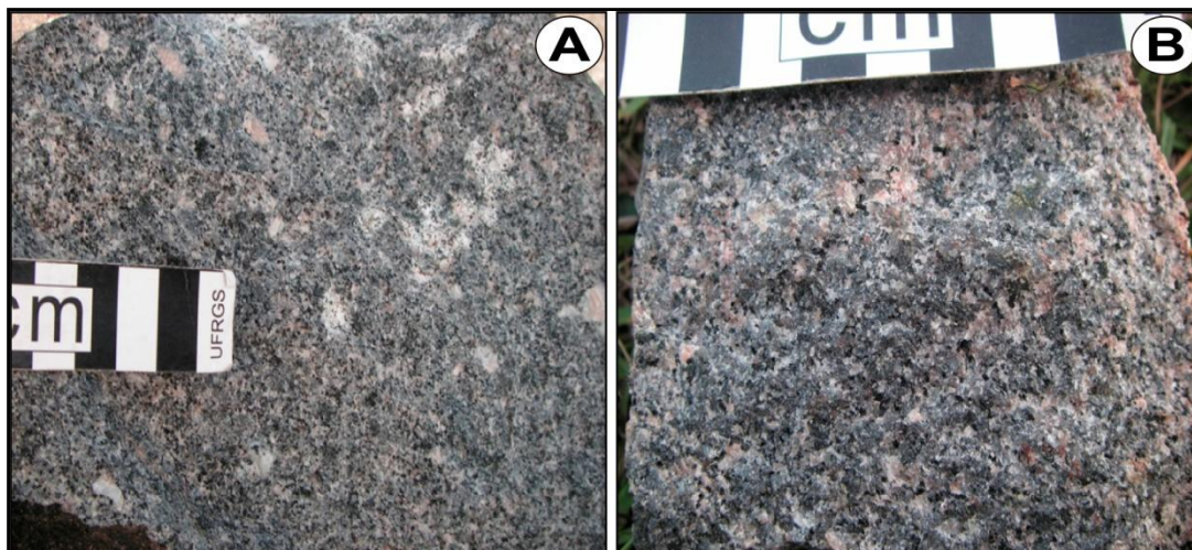
Figura 17: A) quartzo-monzodiorito, textura equigranular média e subordinada textura porfirítica, mais máfico. Ponto MJ-13. B) quartzo-monzonito, textura equigranular média, mais félsico. Ponto MJ-13.
