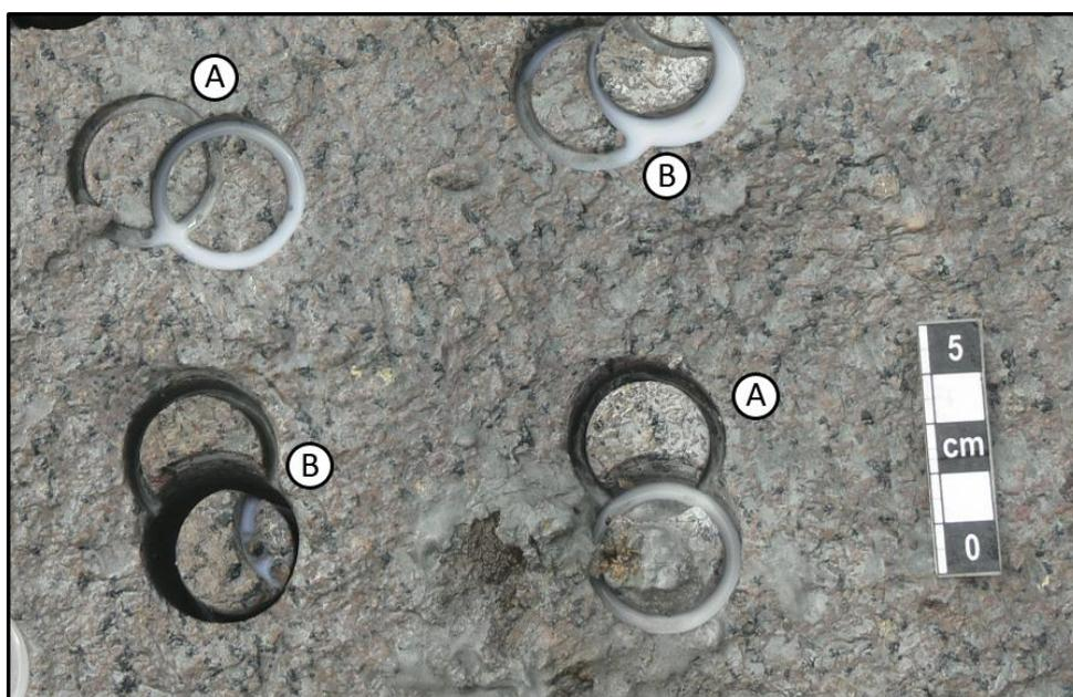
Figura 8) (A) Cilindros que não quebraram com a perfuração; (B) Cilindros que quebraram com a perfuração, mas serão facilmente recolocados na posição correta devido a marcações previamente feitas.
