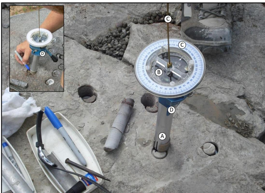
Figura 9) Orientador dos testemunhos cilíndricos: (A) Haste de alumínio com ranhura na base; (B) Bússola tipo Brunton acoplada; (C) Transferidor de 360° e haste de metal, para leitura do azimute solar; (D) Transferidor de 90° para medir a inclinação do furo.
