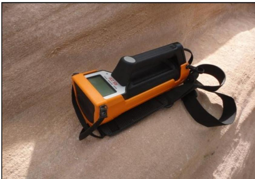
**Figura 10:** Aparelho gamaespectrométrico modelo RS-230 *Super Spec*, cedido pela UFSC.
